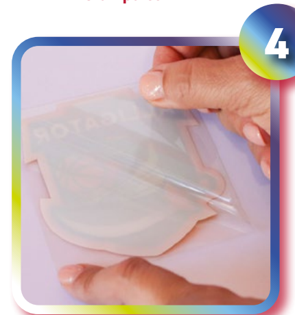
4 Applicazione - Stacco liner (A)
