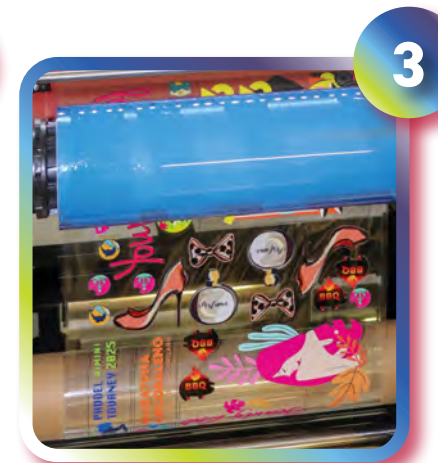
3 Laminazione automatica transfer UV DTF (film A+B)
